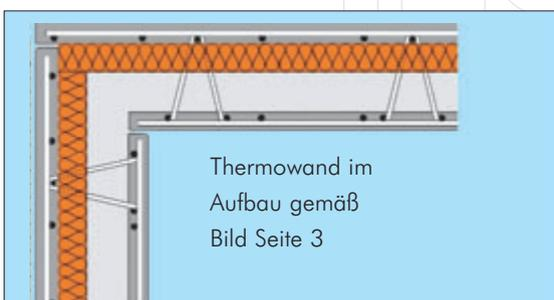
Vorteilhafte Thermowände im Vergleich zu klassischen Sandwich-Konstruktionen
