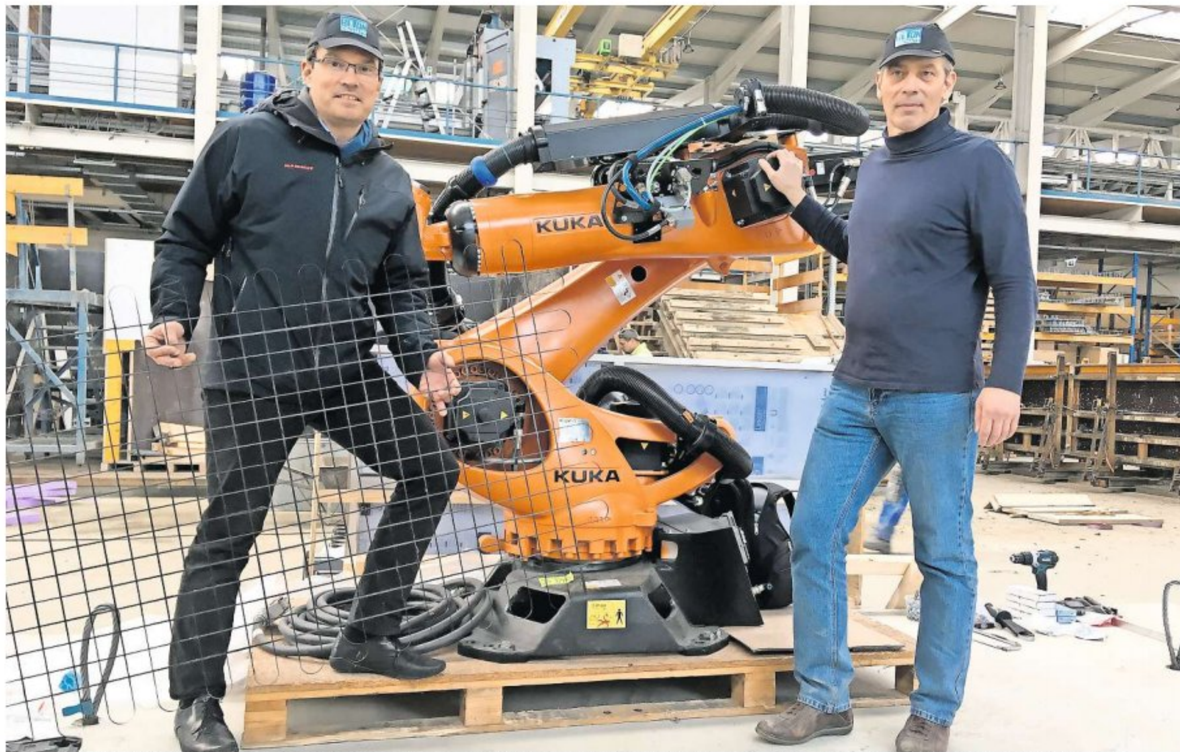
Betonwerk-Geschäftsführer Matthias Schurig und Martin von Zuben von der TU Dresden (r.) mit dem Roboter zur Garnablage. Matthias Schurig hält ein Carbon-Gelege in den Händen.
