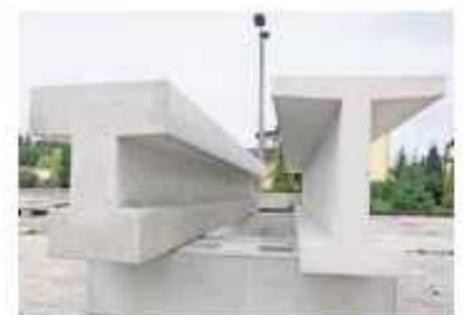
Deutlicher Unterschied: Bei gleicher Belastbarkeit ist der Binder mit Carbon-Bewehrung (r.) deutlich schlanker als ein Stahlbeton-Bauteil.
