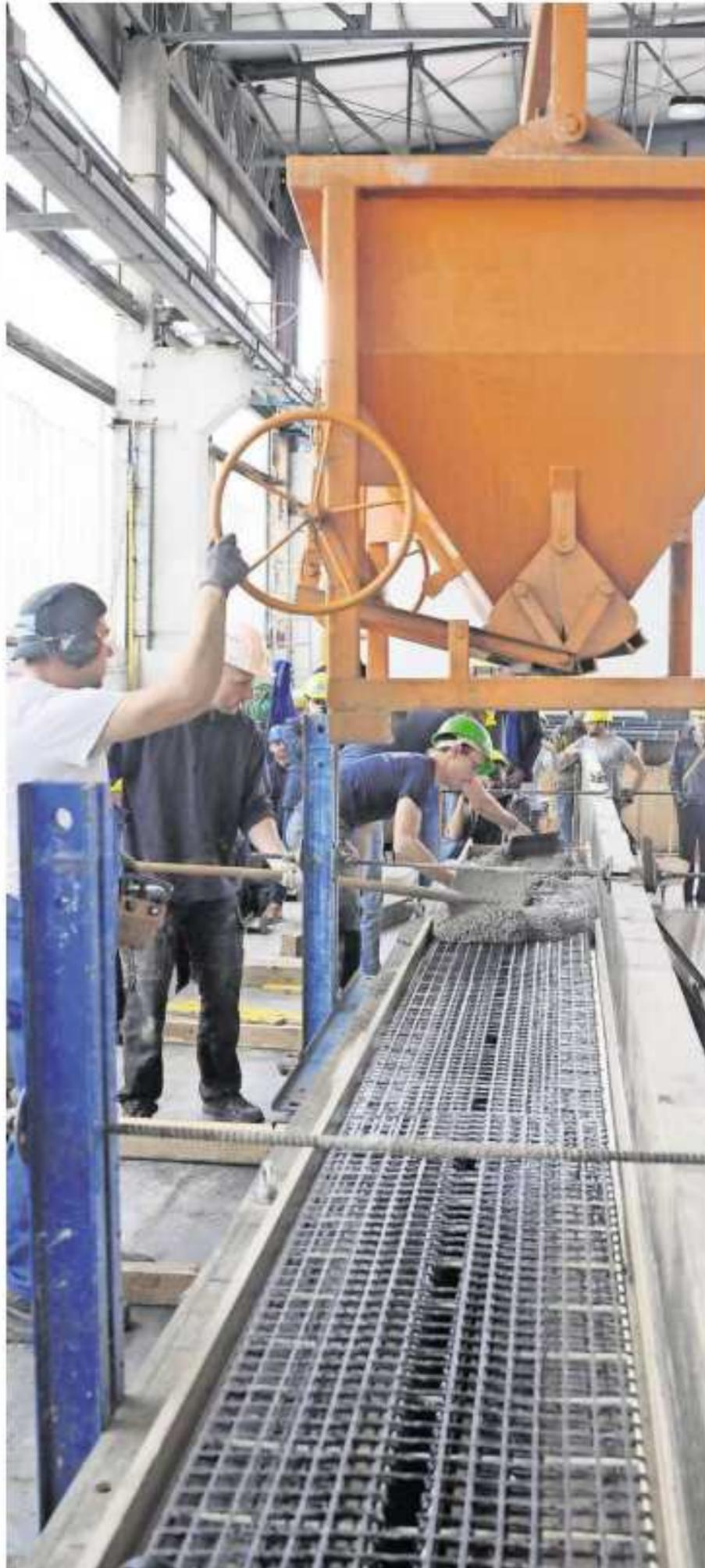
Carbon statt Stahl: Das Betonwerk Oschatz testet eine neue Technologie zum Herstellen von Bindern, beobachtet von Vertretern aus Industrie und Forschung. Fotos: Dirk Hunger
