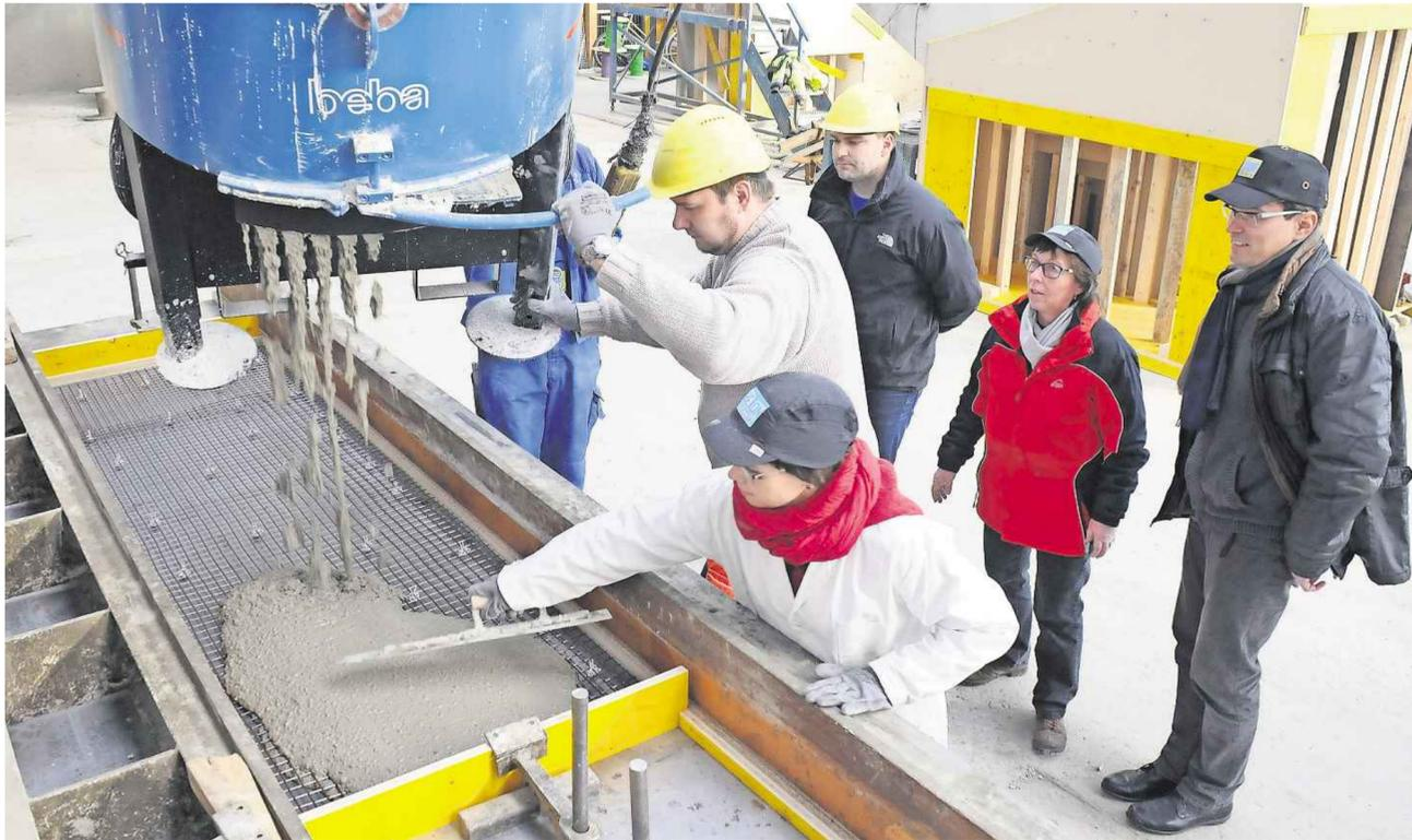
Sieht fast aus wie immer, könnte aber den Betonbau grundlegend verändern: Diese Probelplatten werden mit Carboneugebe anstelle von Stahl stabilisiert.
