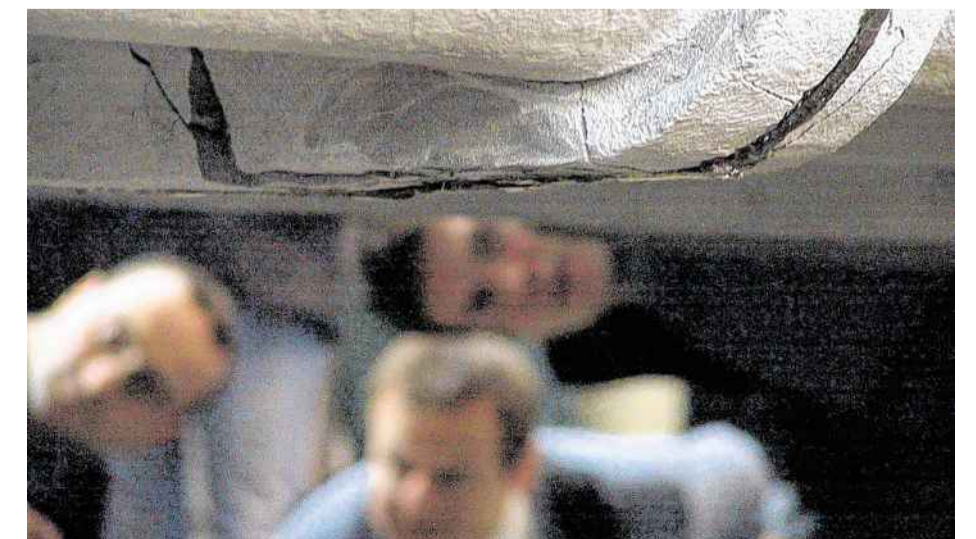
Nachdem mehr als das Dreifache der Last, für die die Oschatzer Brücke bestimmt ist, auf den Prototyp einwirken, zeigen sich erste Risse.
